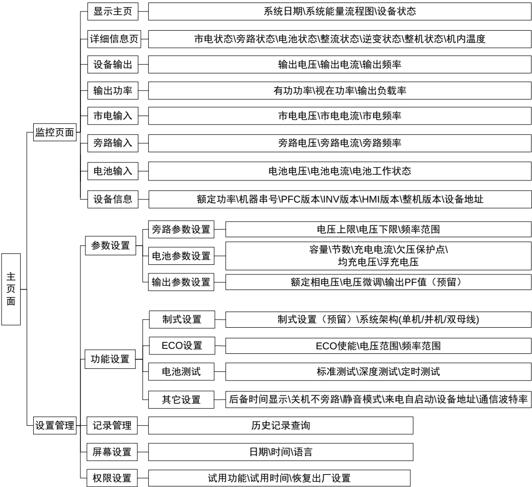
图4-1 液晶屏菜单结构树
