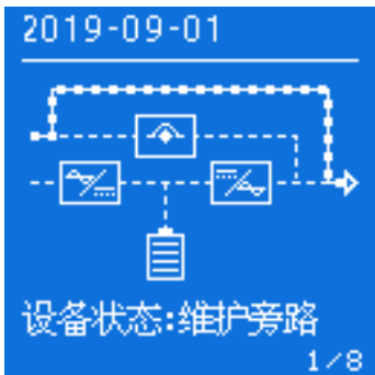
图4-8 维护旁路输出
