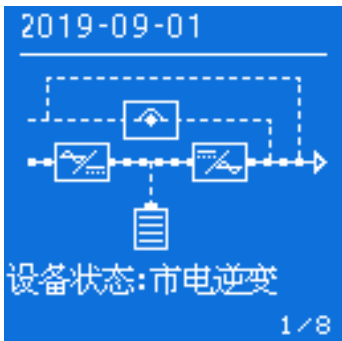
图4-5 市电逆变输出
